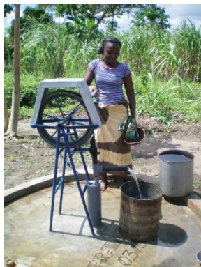
Bomba de cuerda: El giro de la rueda hace ascender el agua desde el fondo
